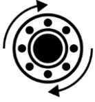
Les parties mobiles en rotation sont équipées de doubles roulements à billes étanches en inox. Les roulements sont encastrés dans la partie mobile et reposent sur un épaulement.
